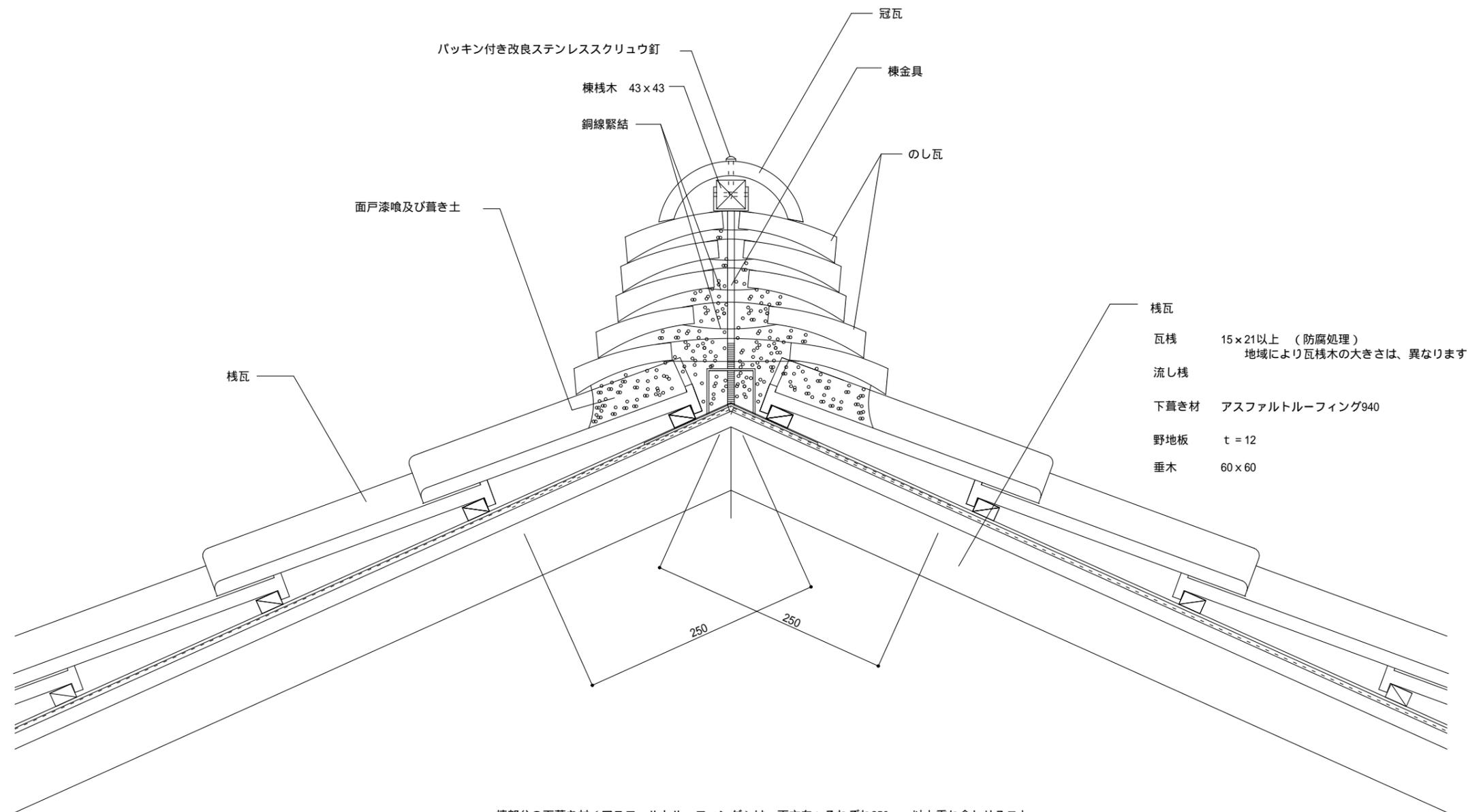
棟部分の下葺き材(アスファルトルーフィング)は、両方向へそれぞれ250mm以上重ね合わせる事。
