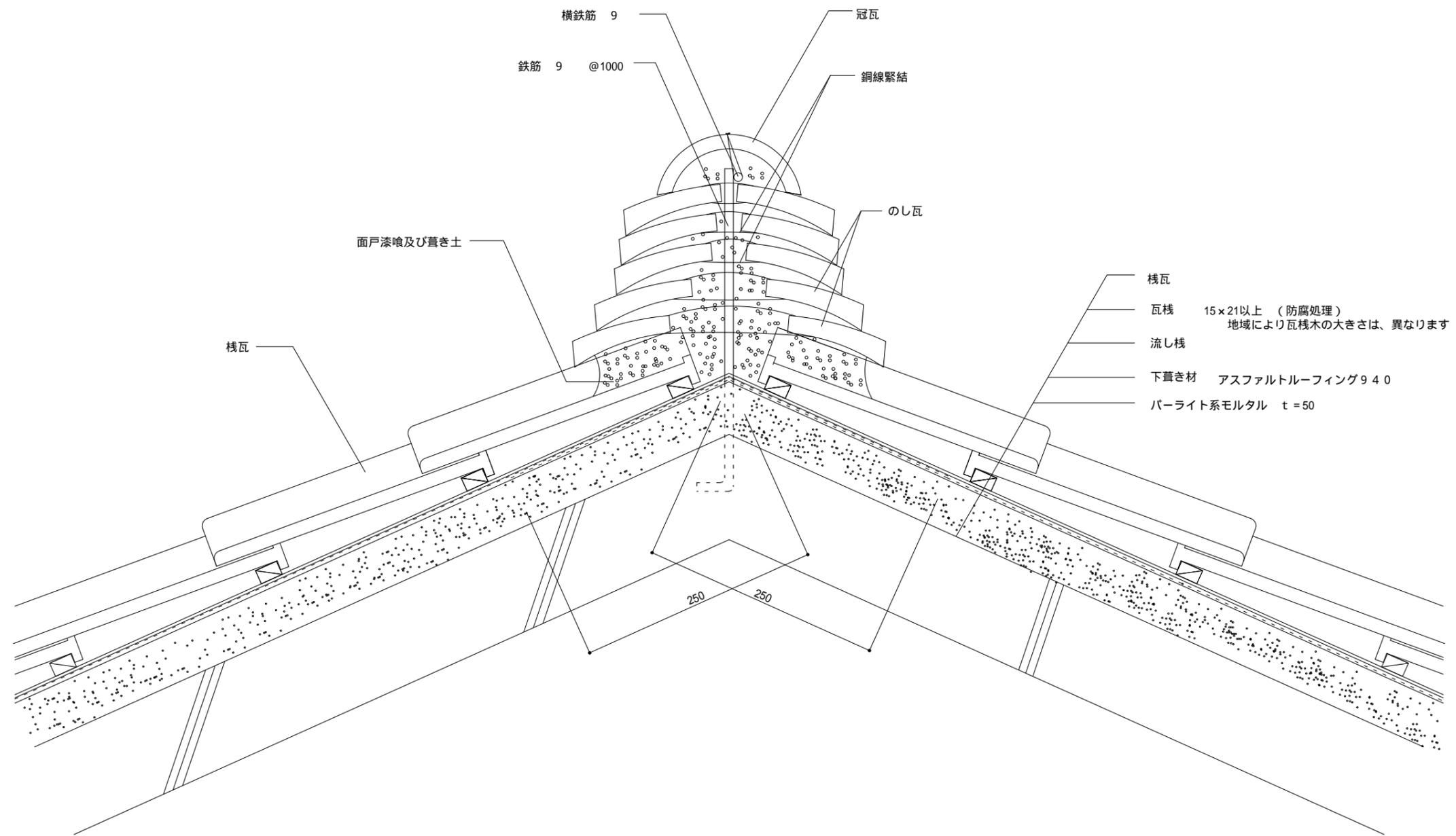
棟部分の下葺き材(アスファルトルーフィング)は、両方向へそれぞれ250mm以上重ね合わせること。
