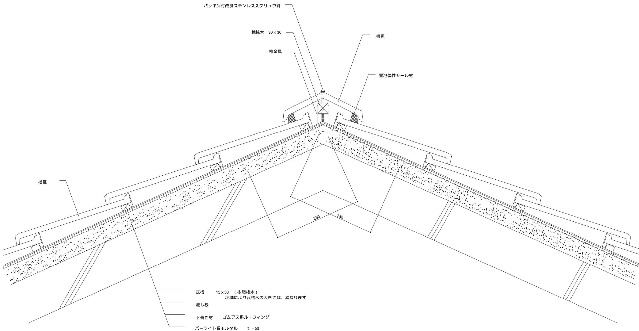
棟部分の下葺き材（ゴムアス系ルーフィング）は、両方向へそれぞれ250mm以上重ね合わせる事。
